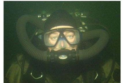
Ein Vorteil: die Blasen der Ausatemluft werden über den Ausatemschlauch hinter den Taucher geleitet und stören nicht im Sichtfeld.
