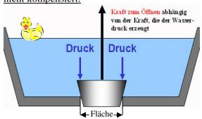
Die Kraft zum Öffnen des Ablasses ist abhängig vom Wasserstand und von der Fläche des Stöpsels.
