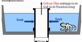
Die Kraft zum Öffnen des Ablasses ist unabhängig vom Wasserstand und von der Fläche des Stöpsels.
