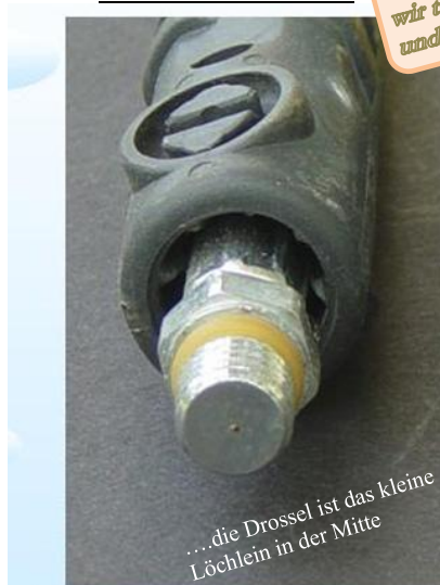
...die Drossel ist das kleine Löchlein in der Mitte Finimeteranschluss 7/16" mit Drossel
